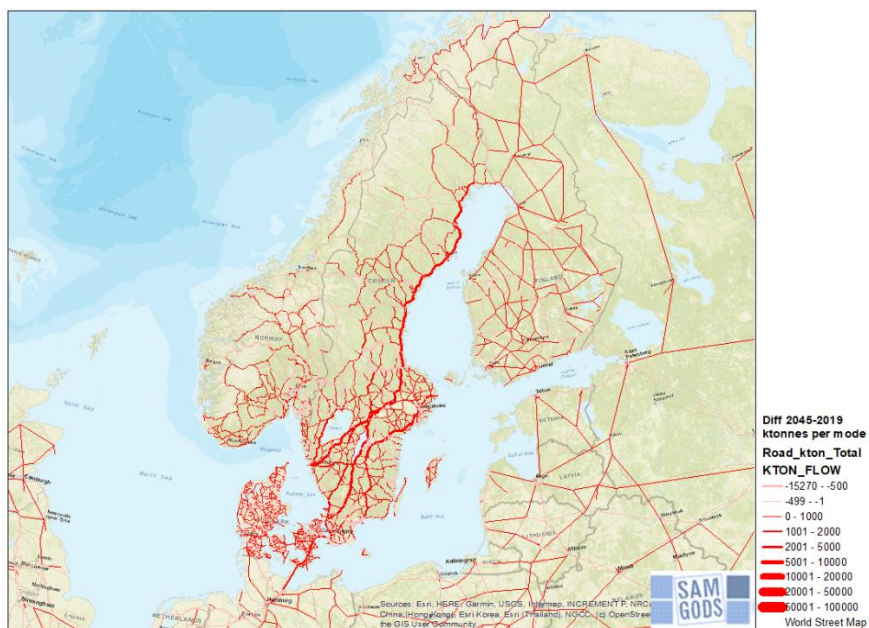
Fig 6.10 Volymförändringar i scenariet med 74 tons lastbilar jämfört med basprognosen för 2045 (kton per år)
