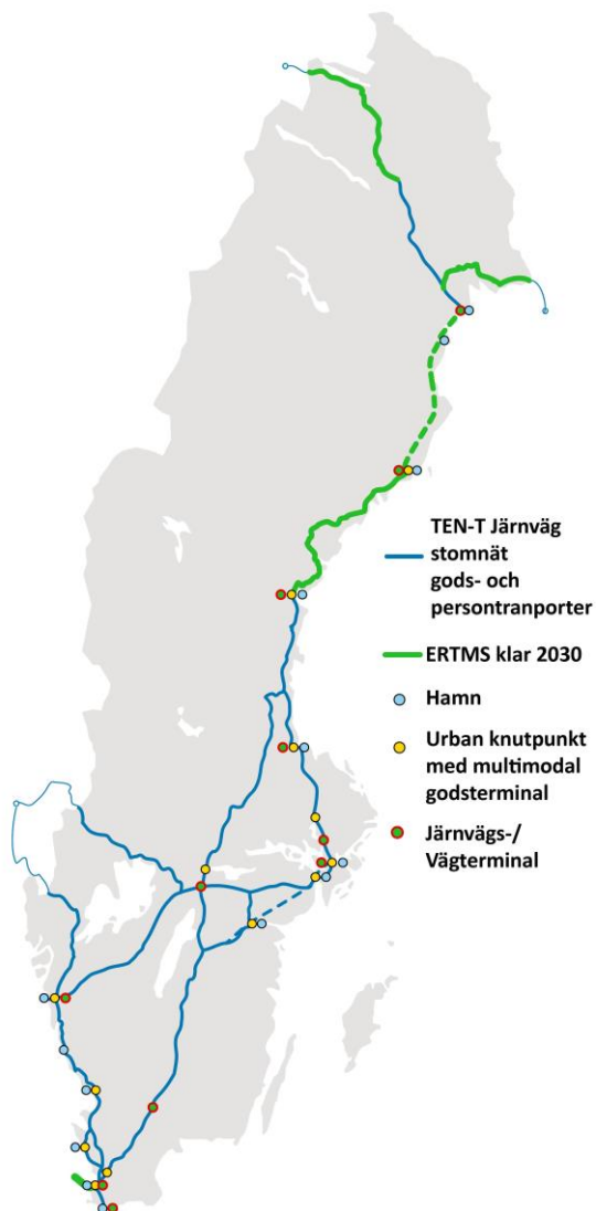
Figur 2.14 Kartan visar det järnvägsnät som ska vara utrustat med ERTMS 2030. Kravet inkluderar anslutningar som bedöms nödvändiga. Grönmarkerade sträckor bedöms uppfylla kraven 2030. Norrbotniabanan, Umeå–Luleå uppfyller kravet när den öppnas för trafik.
