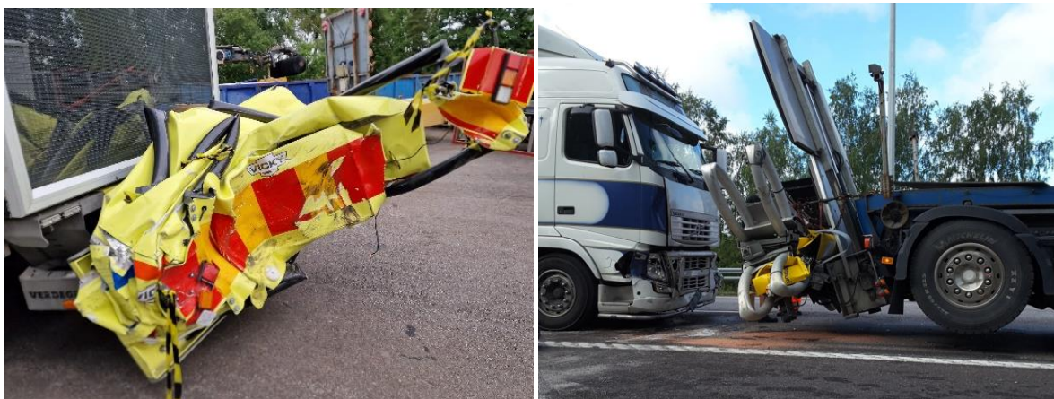
Två påkörda TMA-skydd. På bilden till vänster har en personbil kört in i skyddet och på den högra bilden har en lastbil kört in i skyddet. Foto: Thomas Samuelsson respektive Peab AB.
