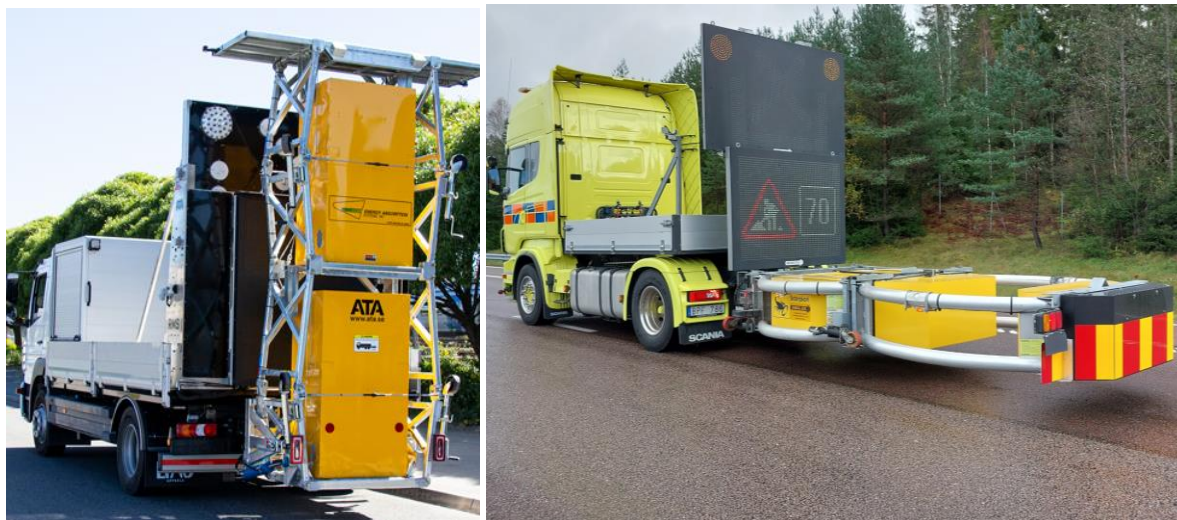
TMA-fordon under färd med skyddet uppfällt. TMA-fordon på plats på vägarbetet med skyddet nedfällt. Foto: ATA respektive Eva Liljegren.
