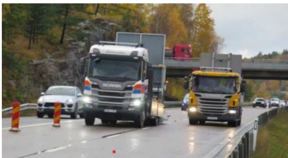
Foto från en kontroll där TMA-föraren i det vänstra fordonet låg och sov i utrymmet bakom förarstolen. TMA-skyddet är dessutom alldeles för lågt. Foto: Claes Hedberg.
