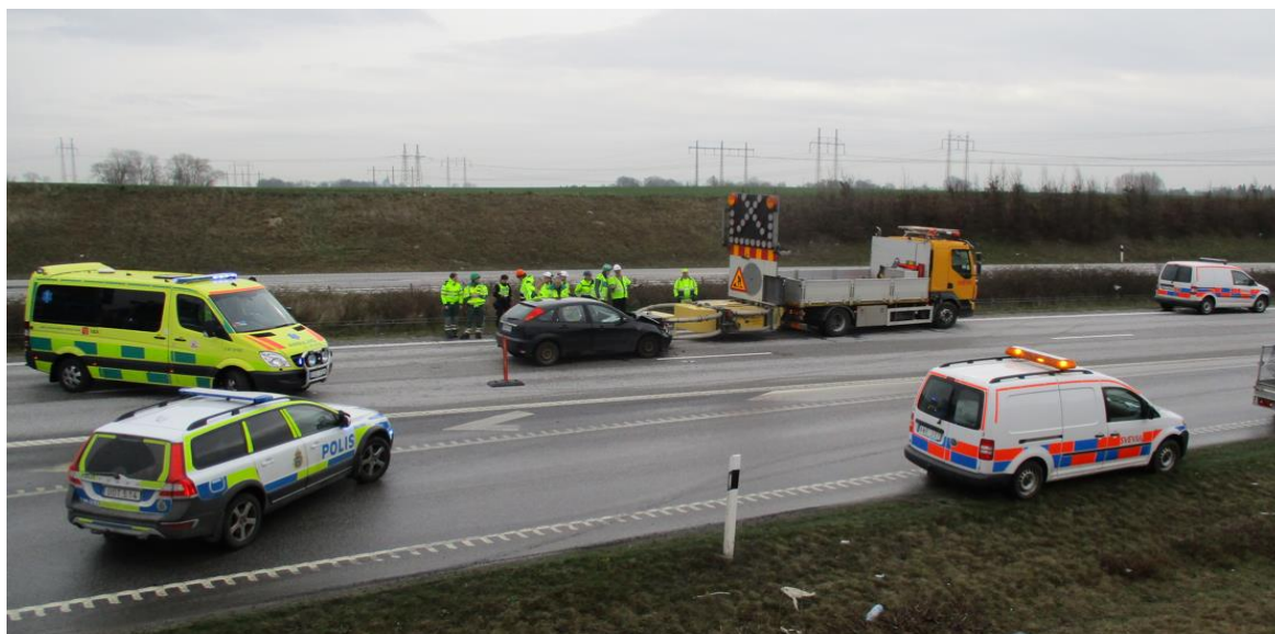
En trafikolycka där ett TMA-skydd blivit påkört av en personbil. Foto: Svevia.
