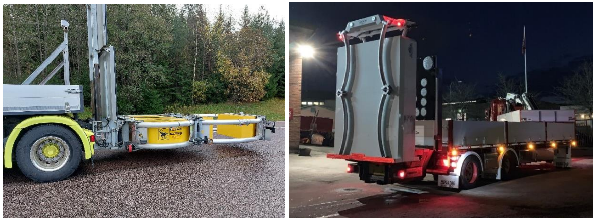
Ett nerfällt TMA, monterat på en lastbil och ett uppfällt TMA, monterat på ett släp. Foto: Eva Liljegren respektive Vicky Teknik.
