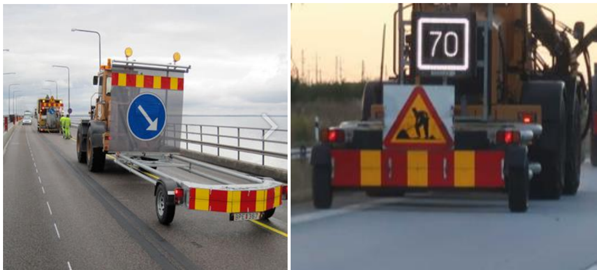
På bilden till vänster ses en alternativ bärare med TMA-trailer. På bilden till höger är TMA-skyddet monterat på en hjullastare. Foto: Ramudden respektive Claes Hedberg.
