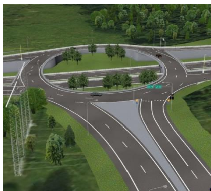
Bild 11 Bilderna visar planerade trafikplatser där sekundärvägarna leder rakt mot rännet. En bil som kör genom rännet kanske inte hamnar på den undre körbanan däremot innebär den stora nivåskillnaden, samt i ena fallet träd, att personer i den genomkörande bilen riskerar svåra personskador. De (uppvuxna) träden kan ge en viss optisk vägledning, men förvarnar inte om den stora nivåskillnaden.
