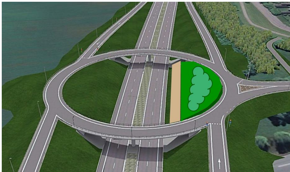
Bild 12 Med hjälp av en stödmur nära den lägre körbanan kan en större plan eller t o m upphöjd yta skapas. Den tillskapade ytan kan för ökad synlighet planteras med buskar.
