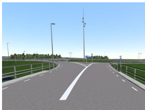
Bild 11 Bilderna visar planerade trafikplatser där sekundärvägarna leder rakt mot rännet. En bil som kör genom rännet kanske inte hamnar på den undre körbanan däremot innebär den stora nivåskillnaden, samt i ena fallet träd, att personer i den genomkörande bilen riskerar svåra personskador. De (uppvuxna) träden kan ge en viss optisk vägledning, men förvarnar inte om den stora nivåskillnaden.
