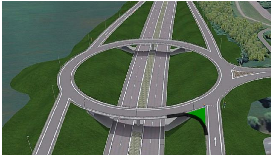
Figur 9 Ytan i den spetsiga vinkeln mellan anslutande ramp och cirkulation har fyllts ut och raket öppnats upp för bättre sikt
