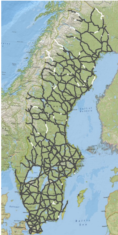
Figur 13 Täckning av publik snabbladdning på minst 150 kW var 10:e mil längs funktionellt prioriterat vägnät för långväga personresor och var 6:e mil längs TEN-T. Vita sträckor visar avsaknad av laddning. Data från våren 2023.
