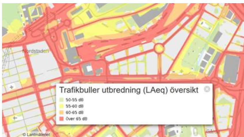
Figur 12. Utbredning av trafikbuller kring Centralstationen i Göteborg.
