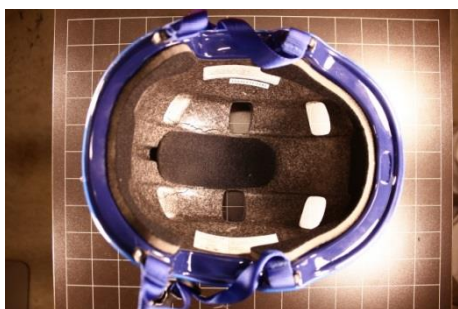
Figur 4 Sprickor i hjälm efter mätning
