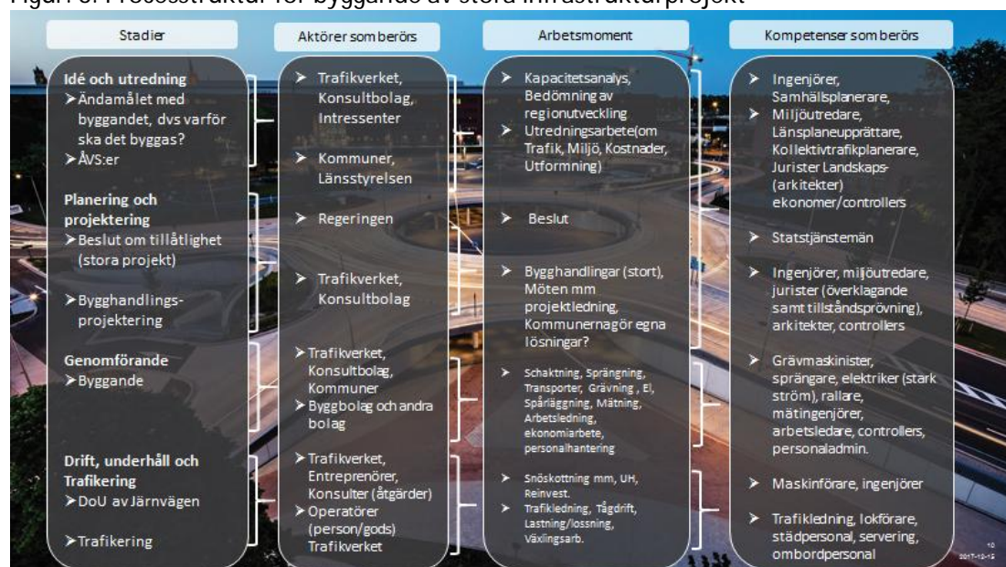
Figur. 6. Processtruktur för byggande av stora infrastrukturprojekt
