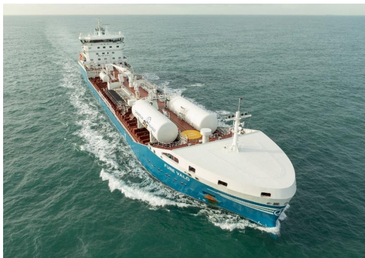
Figur 26. Fure Valö på öppet vatten. Eftersom fartyget av stabilitetsskäl måste lasta med barlastvatten är det svårt att se fartygets aktuella fyllnadsgrad genom fartygets vikt. Foto ©Furetank
