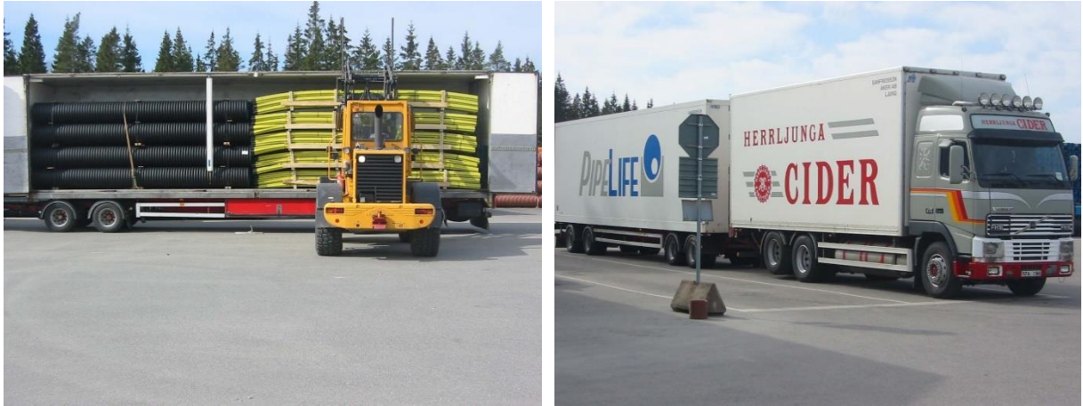
Figur 5. Genom samverkan mellan tillverkare av skrymmande lätta plaströr och tyngre dryck kan lastbilen med släp maximera sin fyllnadsgrad avseende både vikt och volym. Foto: Conlogic.
