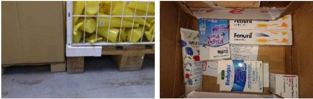
Figur 7. Till vänster: Lastpallar med lägre höjd möjliggör fler produkter i samma lastbärare. Inom containertransport förekommer även s k "slip sheet" som knappt fordrar någon höjd alls. Till höger: Transportförpackningens fyllnadsgrad vid hemleverans av apoteksprodukter. Foto: Conlogic
