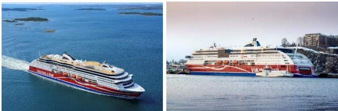
Figur 34. Viking Grace är Viking Lines modernaste fartyg och som med s k "dual fuel" motorer drivs den med flytande naturgas (LNG). I början av 2022 kommer Viking Lines nya tillskott Viking Glory som också kommer att drivas med LNG. Med denna framdrivning kan även biogas användas som skulle sänka utsläppen av växthusgaser väsentligt. Motorerna kan även drivas med diesel om detta skulle behövas. Till höger bunkring av Viking Grace med LNG från en bunkerbåt i Stockholm. Foto ©Viking Line
