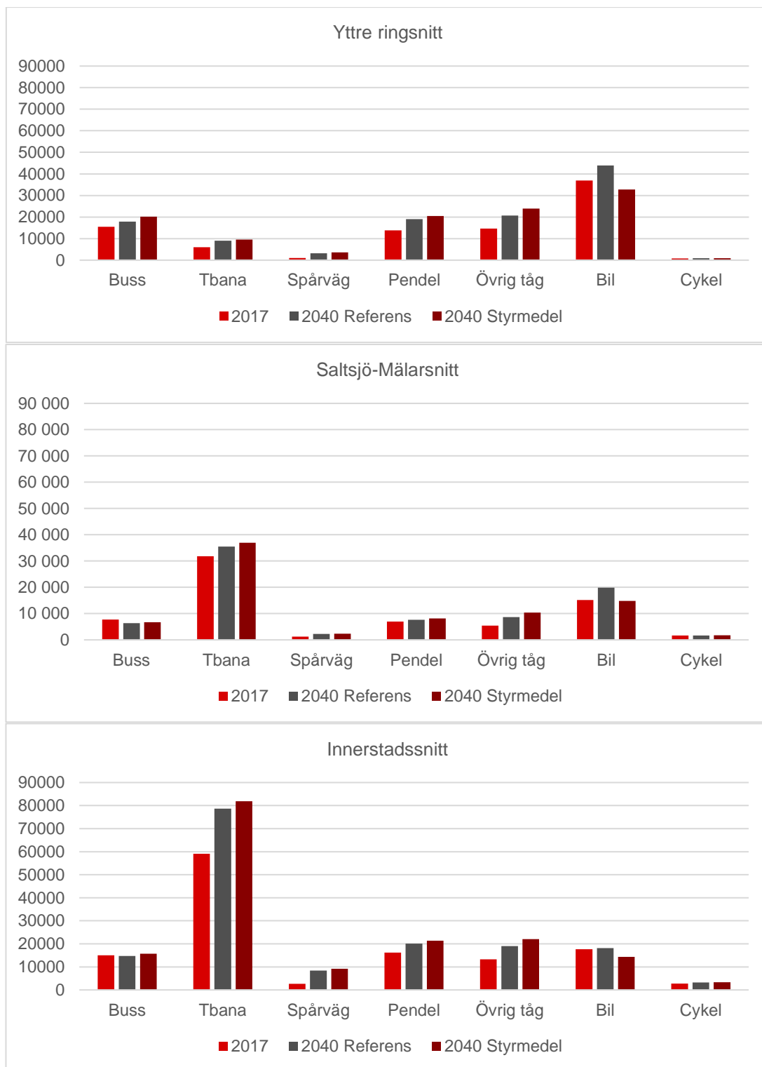
Figur 8 Resande över de tre snitten i riktning under morgonens högtrafik. Källa Trafikverkets basprognos, version 2020-06-15, bearbetning M4Traffic.
