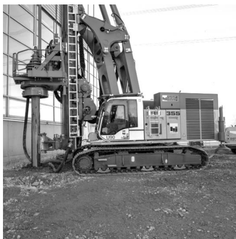
Figur 50. Full-displacement pile med vibrerande teknik från (www.liebherr.com)
