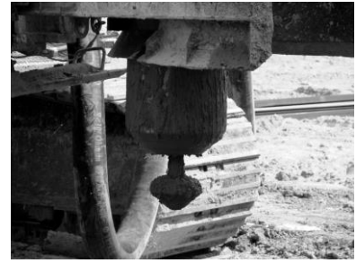
Figur 28. Ventil som öppnas när röret dras uppåt (T. Forsberg)
