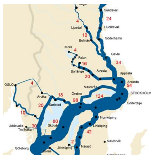
Figur 2.7: Linjenät med långväga dagtågstrafik med i huvudsak långväga resande, totalt antal tåg/dygn år 2019.
