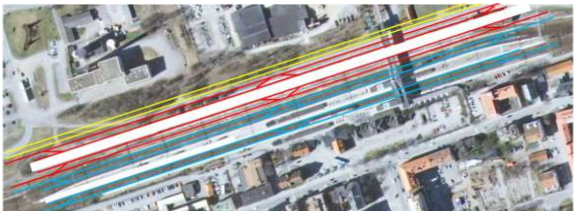
Figur 6.3 Förslag på ny spårdisposition för Hallsbergs personbangård. Källa: Arbetsmaterial från Funktionsutredning Hallsberg, framtida tågproduktion.
