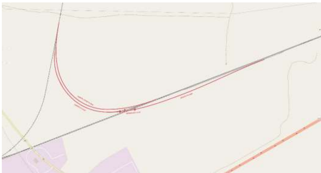
Figur 6.4 Skiss som illustrerar ny planskild förbindelse mellan Västra stambanan och Värmlandsbanan i Laxå Östra.
