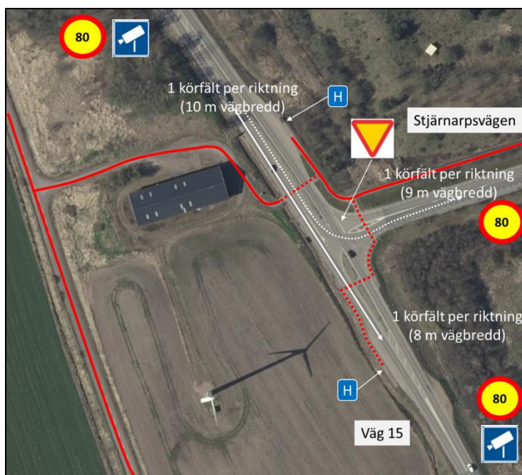
Nuläge av korsning väg 15 och väg 552 (Stjärnarpsvägen) med antal körfält, cykel- och gångvägar, busshållplatser, hastighetsbegränsning och trafiksäkerhetskameror (ATK)
