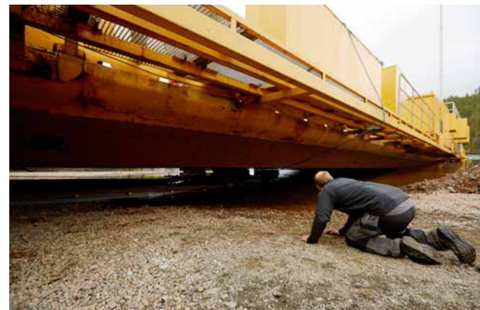
Christopher Wänerbris kollar att färjan ligger rätt på den första slipvagnen. Lee-Flora ligger på tre slipvagnar och dras upp på land med hjälp av en vinsch.
