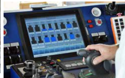
Pekskärmar visar detaljerat statusen för de två Volvo Pentamotorerna på vardera 650 hästkrafter.
