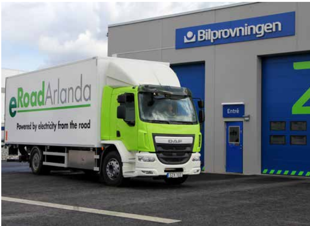
Bilen har två navmotorer som är inbyggda i bakaxeln, med en sammanlagd effekt på 226 kilowatt. De väger 500 kilo styck. Batteriet väger 600 kilo. Hela bilen väger 18 ton och kan lasta 6,5 ton.
