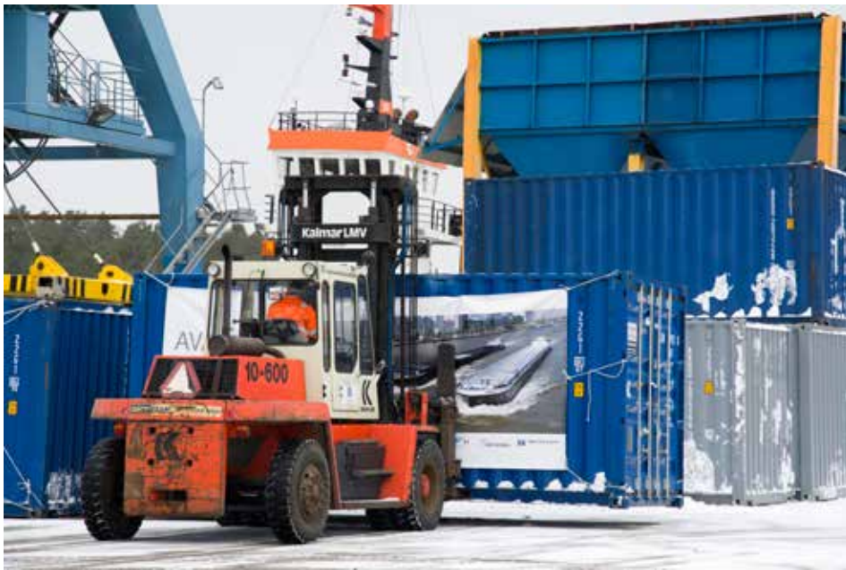
En truck körde containrarna vidare till lastbil, för fortsatt transport. Hamnen i Vänersborg är inte tekniskt optimerad för snabb containerhantering. Men testkörningen fungerade utan problem.
