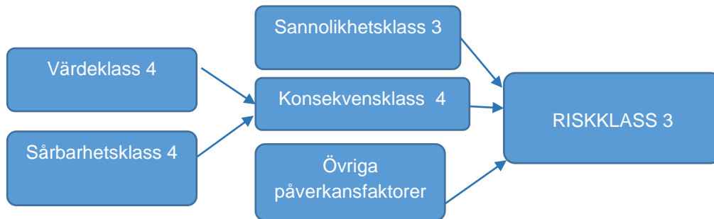
Figur 21. Schematisk bild av riskbedömning för Eldsbergaåsens grundvattenförekomst, väg 15.
