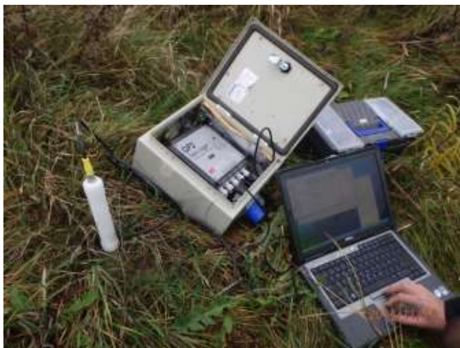
Figur 16. Installerad mätprob i bullervallen, skåp med logger och dator för tömning av mätdata
