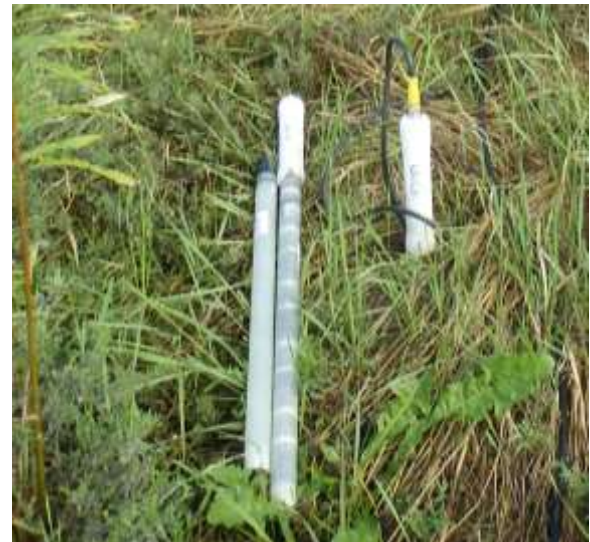
Figur 15. Till vänster principskiss på Profile Probe PR2. Modellen som installerades för mätningar längs väg 201 klarar fyra nivåer samtidigt, modellen till vänster figuren kan registrera sex nivåer samtidigt. Till höger utrustningen som användes i bullervallen.
