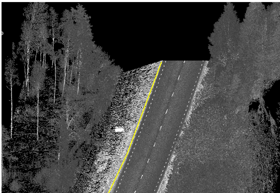
Bild 2.14 Detektering av brytlinje i TerraScan kan ge ett bra resultat men är känsligt för parameterinställning och hur distinkt brytlinjen är i terrängen.
