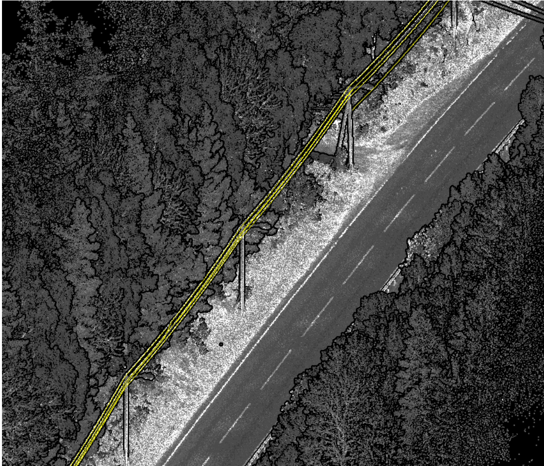
Bild 2.10 Exempel på automatisk detekterad och vektoriserad ledning längs väg O 1040.
