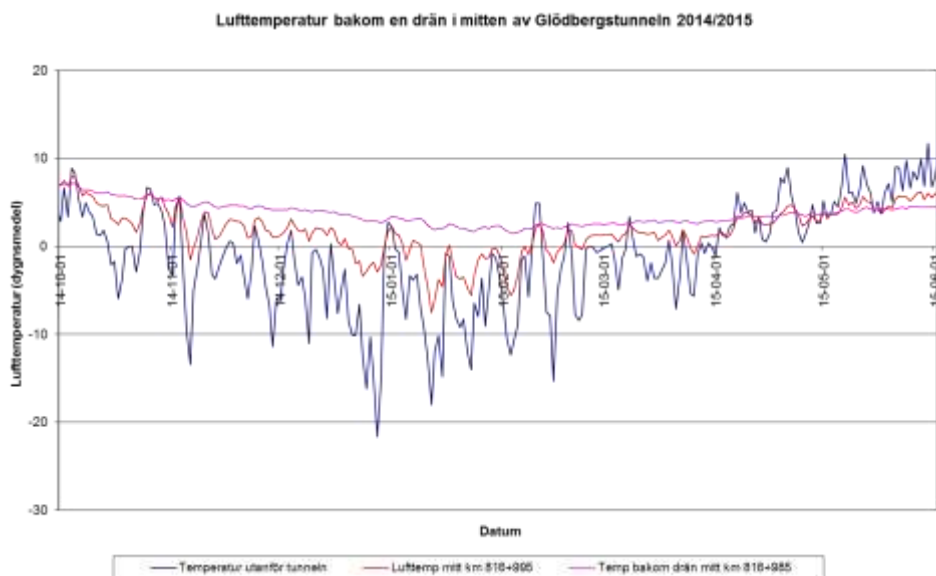
Figur 12 Lufttemperatur bakom en drän i mitten av spårtunneln i jämförelse med uteluftens temperatur och tunnelluftens temperatur under perioden 2014-10-01 till 2015-06-01
