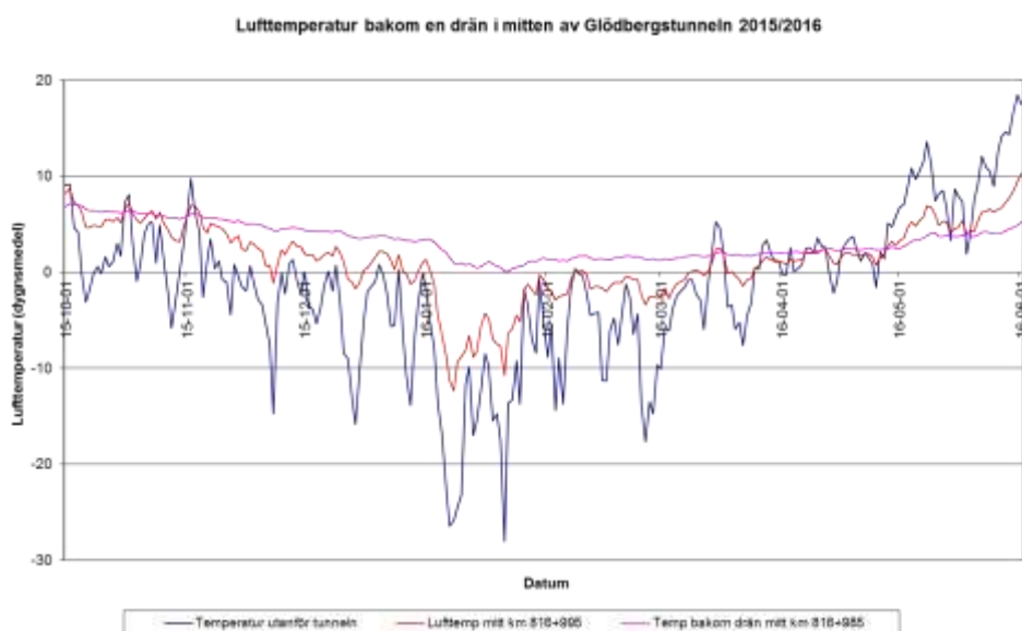
Figur 13 Lufttemperatur bakom en drän i mitten av spårtunneln i jämförelse med uteluftens temperatur och tunnelluftens temperatur under perioden 2015-10-01 till 2016-06-01
