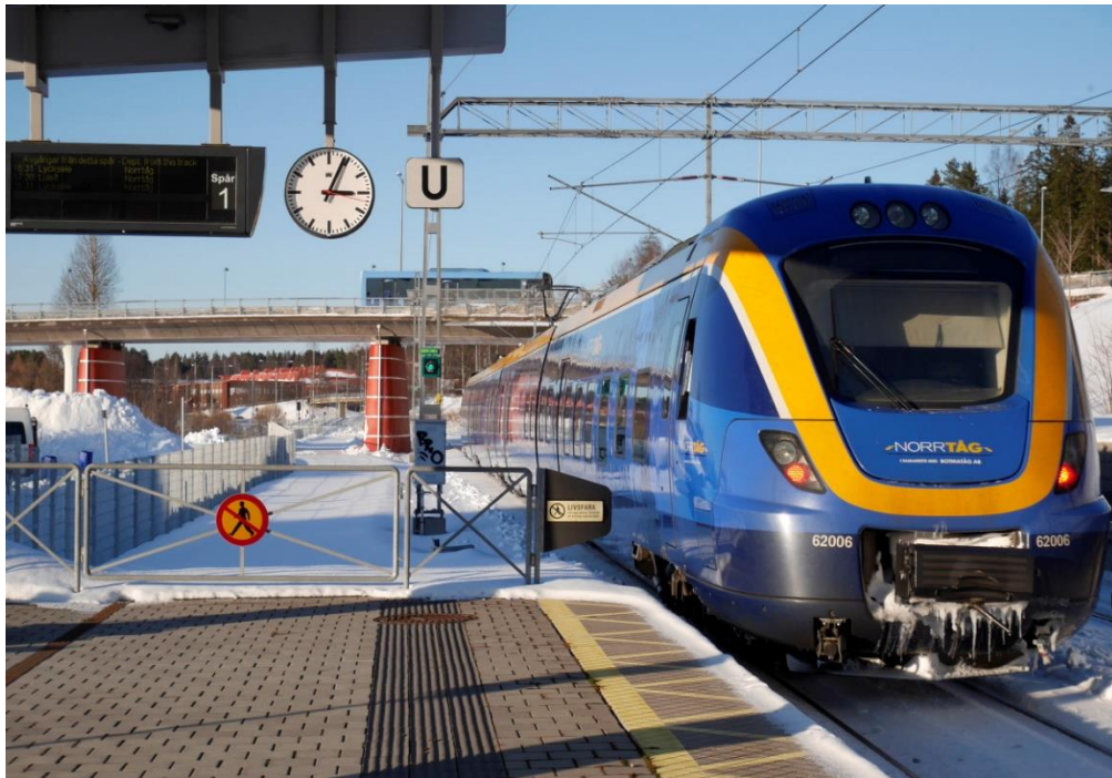
Plattformsändarna är en av de viktiga delarna där omsorg kring avgränsningar kan minska obehörigt spårbeträdande. Bilden är från Umeå Östra.
