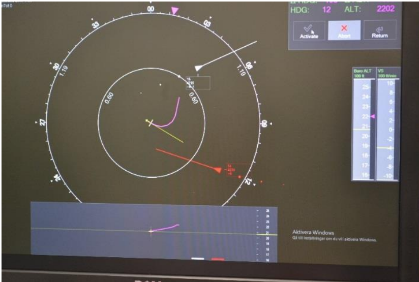
Figur 3 – DAA display i markstationen som visar kollisionsundvikning.
