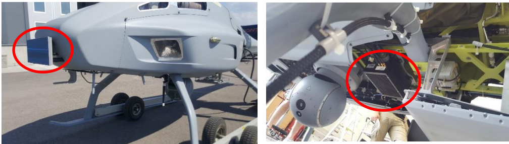
Figur 6 – R5DAA-systemet integrerat på den obemannade Skeldar-helikoptern.
