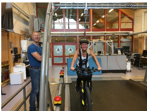
Figur 1. Cykling på rullbandet. Befintliga säkerhetsfunktioner är cykelhjälm, sele fastsatt i portalen, stoppknappar samt kontinuerlig närvaron av experimentledaren. Foto: Christopher Patten.
