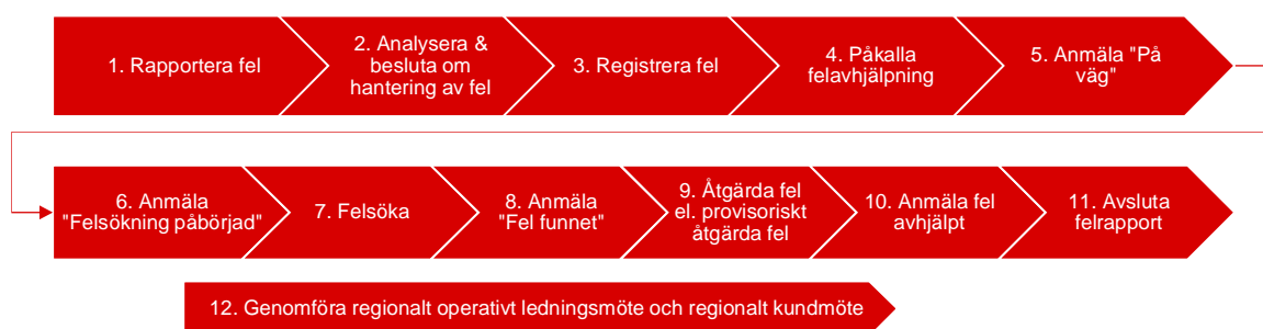
Figur 2 Förenklad processbild för felavhjälpning vid tågstörande fel.
