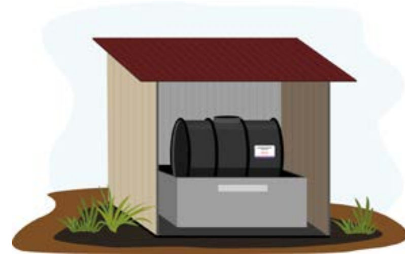
Exempel på invallad och väderskyddad cistern
