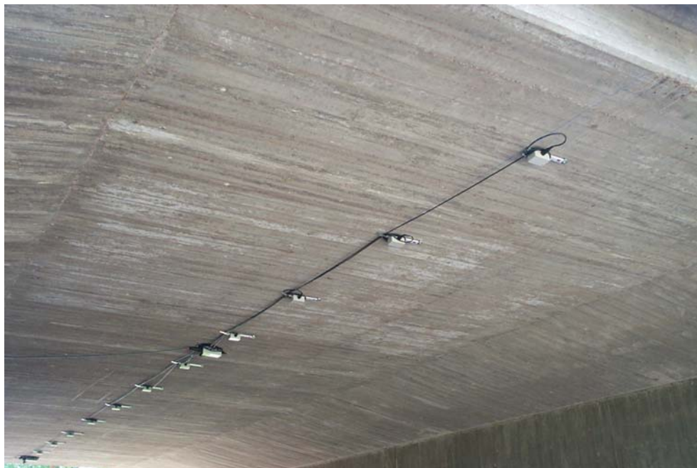
Bild 3-1 Töjningsgivarna monterade på en mätplats
