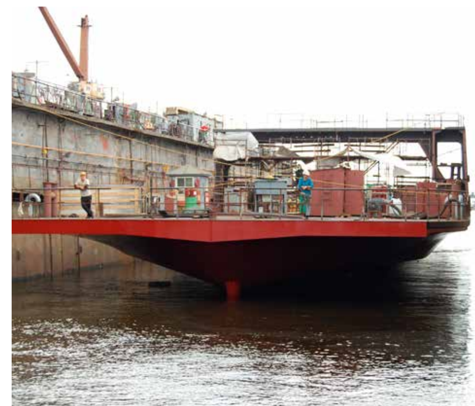
Botten är färdigmålad bortsett från ett antifoulinglager som ska på precis före leveransen av färjan. Foto: Kirill Kaupustin
