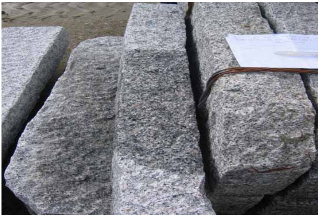
Bild 8 Kinesisk granit använd i studien som skiljelinje (torr och våt yta)
