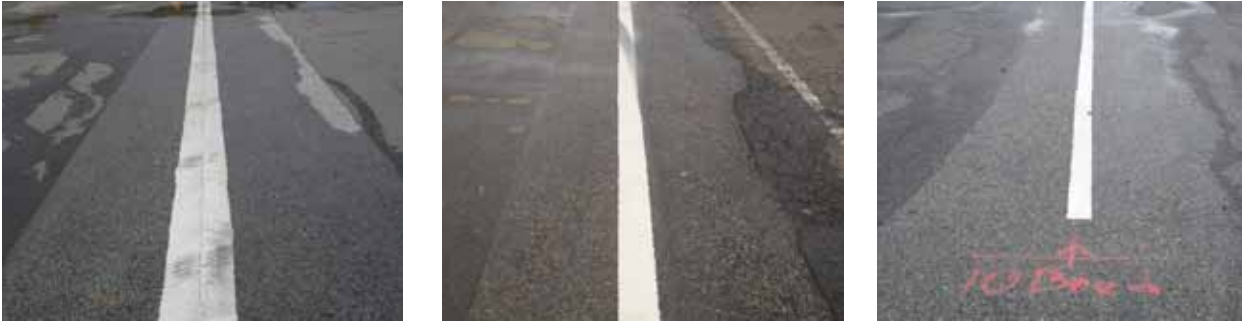
Bild 19-21 STRÅK 11, STRÅK 12, STRÅK 13: Ljushetskontrast 0,45 enligt NCS i bredderna, från vänster till höger, 30 cm, 15 cm respektive 10 cm
