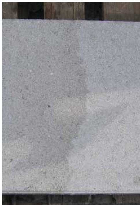
Bild 5-6 Mätning av material till skiljelinje ("vit betongplatta") i studien i torrt och vått tillstånd
