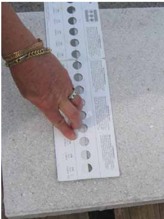
Bild 5-6 Mätning av material till skiljelinje ("vit betongplatta") i studien i torrt och vått tillstånd
