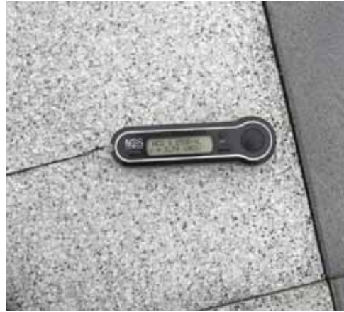
Bild 3-4 Mätning med ljushetsmätare av omgivande material (betongplattor) i studien i vått och torrt tillstånd
