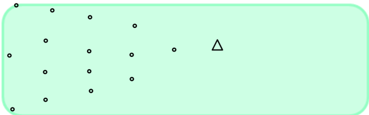
Figur 2 exempel på placering av gemensamma punkter vid etablering av RUFRES då punkterna endast går att placera i en smal sektor. Triangeln utgör RUFRES och de små cirkelarna gemensamma punkter. Den gröna ytan avser arbetsområdet.
