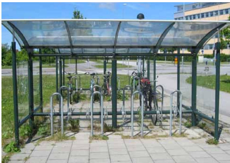
Kombination av hjulhållande och ramlåsande cykelställ. Exempel från Lund. Foto: Trivector Traffic
