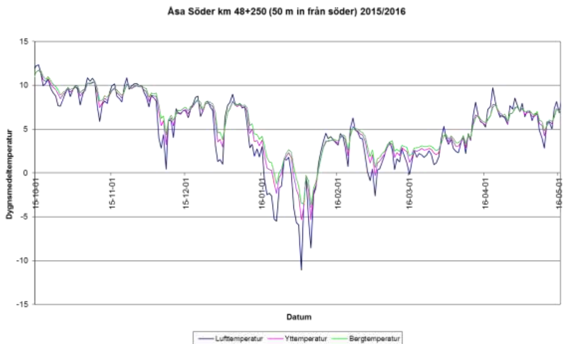
Figur 14 Luft-, yt- och bergtemperatur vid 50 m in från södra mynningen under perioden 2015-10-01 till 2016-05-01
